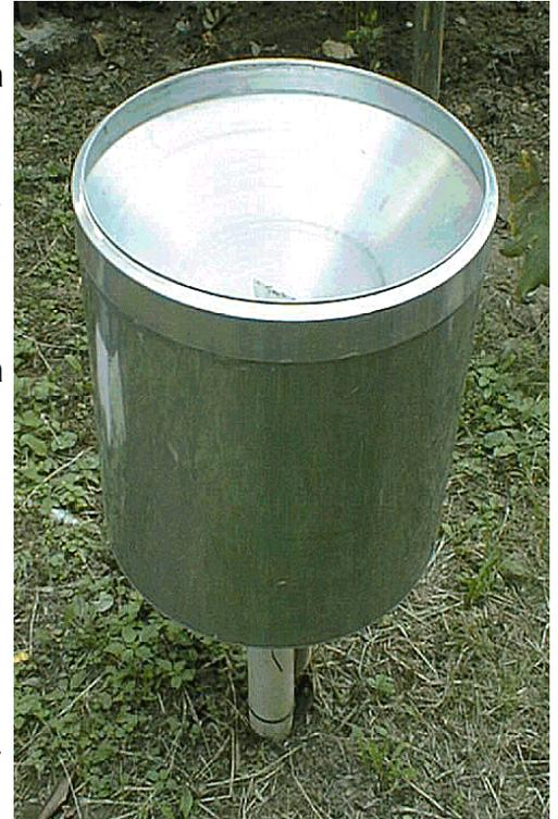
Il sensore pluviometrico E.T.G. è attualmente l'unico sul mercato in grado di assicurare la precisione indicata nelle specifiche su tutto il range di intensità di pioggia da 0 a 330 mm/h grazie ad un avanzato metodo di compensazione software certificato dall'Università di Genova - Facoltà di Ingegneria (Istituto di Idraulica).
